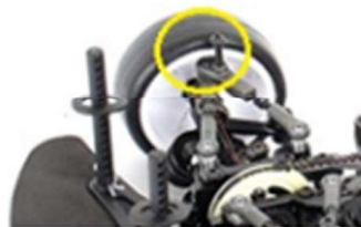
Figura 09 Considerado parte do chassi e evita a bolha tocar nas rodas
