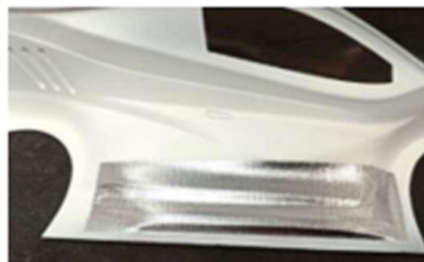
Figura 4 Permitido instalar fitas e malhas de reforços após registo
