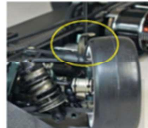
Figura 10 Considerado parte do chassi e evita a bolha tocar nas rodas
