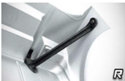
Figura 1 Permitido instalar reforço traseiro após o registo
